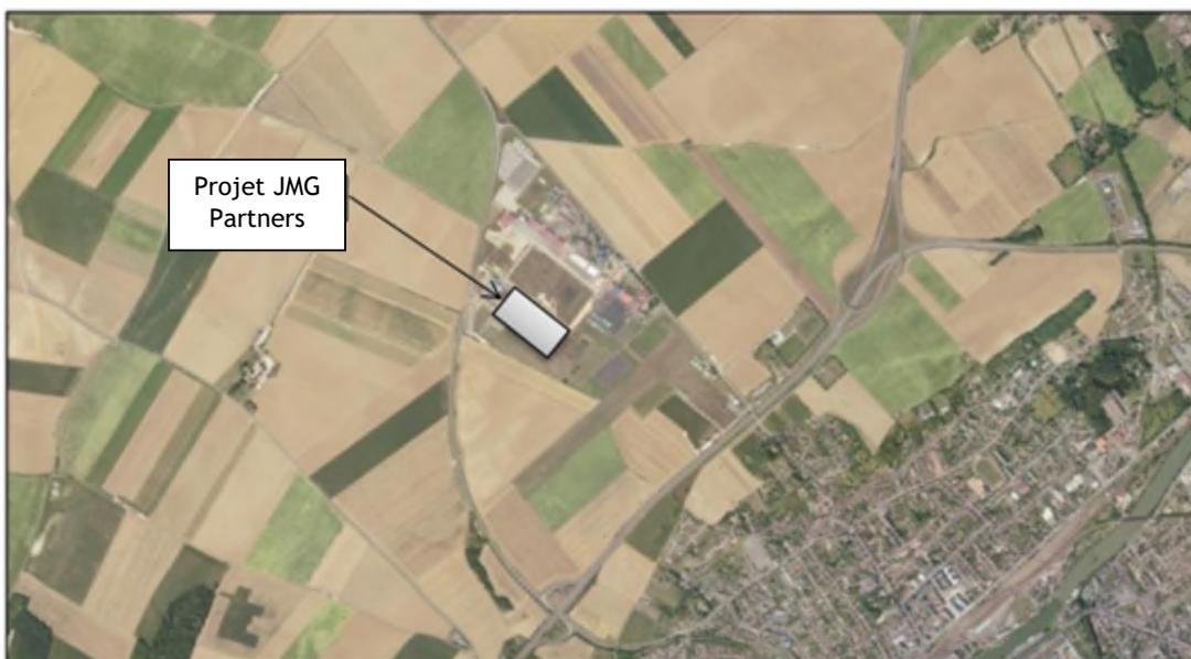
Concernant les risques technologiques, selon le rapport « Partie 1 - Présentation de l'établissement et description des activités » et l'étude des dangers, des flux thermiques ont été calculées via FLUMILOG et les flux de 3 kW/m<sup>2</sup> et de 5 kW/m<sup>2</sup> restent confinés au sein des limites de propriété, grâce à la mise en place d'écran thermiques et de merlons.
